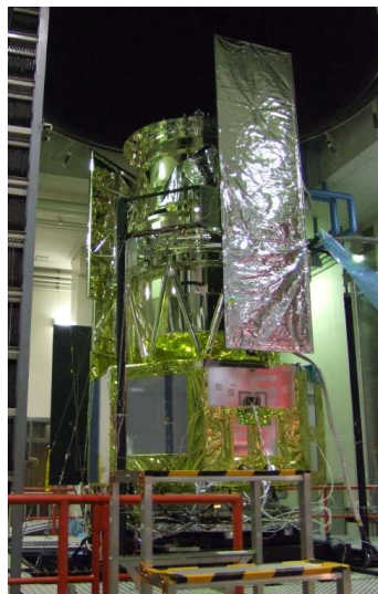
望遠鏡光軸測定 (2005年6月)
