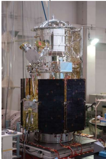
望遠鏡光軸測定 (2005年6月)
