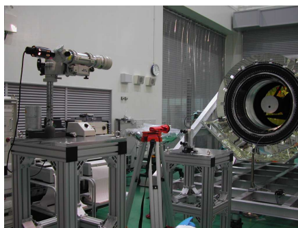
望遠鏡光軸測定 (2005年6月)
