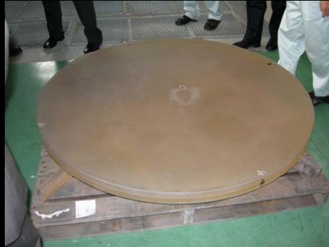
・鏡材(無膨張ガラス材; 直径約1.5m)
