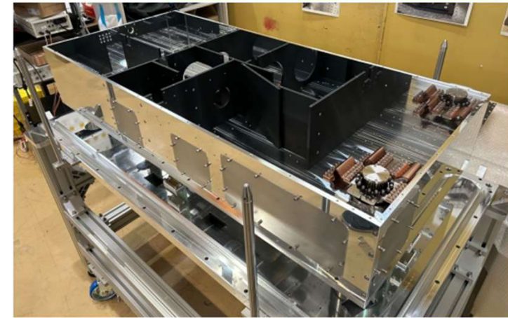
ATCにて組み立て中のNINJA近赤外分光器
